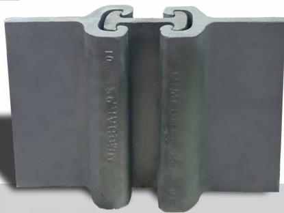
با تغییر استانداردهای وزارت راه و شهرسازی، قالب‌های نیو جرسی اولیه از رده خارج شده و نیو جرسی‌های مفصلی به عنوان جایگزین آن‌ها معرفی گردیده‌اند. این قالب‌ها با استفاده از یک قطعه فولادی به صورت نر و ماده که به آن مفصل نیو جرسی گفته می‌شود، به یکدیگر متصل می‌گردند. تولید این قطعه بر اساس استاندارد اروپایی **GS20-MN5** انجام می‌شود و شرکت سازه گستر مدت‌باز موفقیت مجوزهای لازم از وزارت راه و شهرسازی و سازمان ایمنی راه‌ها را کسب نموده است.
